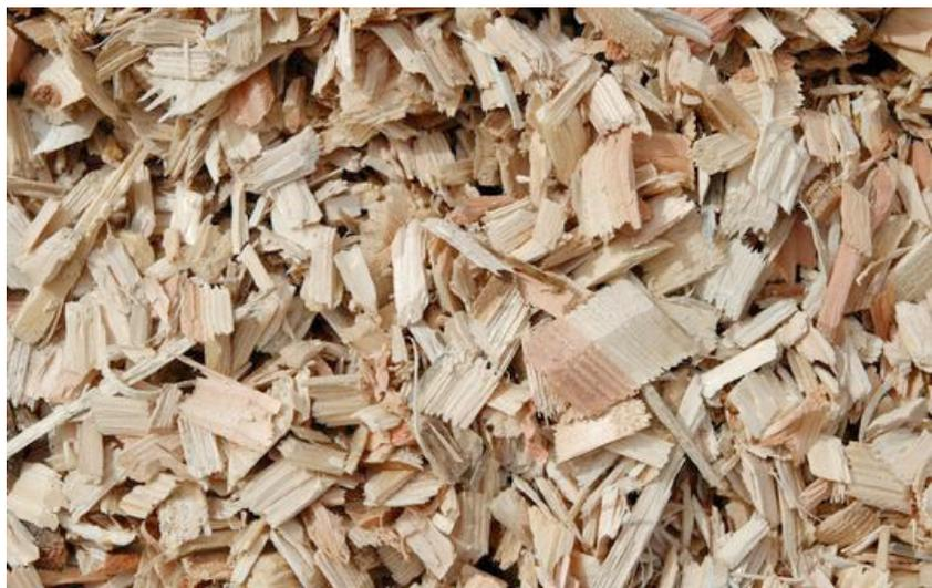
La fibre de bois provient du défilage de chutes de bois résineux. Les fibres sont ensuite liées entre elles par polyuréa ou fibres conjonctives, procédé sec ou par air chaud. De par sa porosité naturelle et la composition de ses fibres, le bois est un isolant performant.
