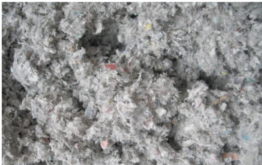
Les isolants à base de cellulose sont obtenus par le broyage mécanique de vieux papier. D'abord déchiqueté, le produit est additionné de  $\pm 4\%$  d'acide borique et sels anorganiques comme équipement anti-incendie. Après réduction en flocons, ceux-ci peuvent être directement insufflés en projection sèche ou humide.
